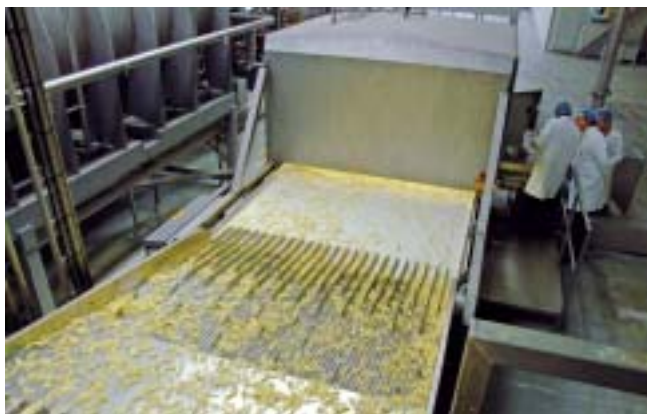
Les produits découpés arrivent sur un tapis vibrant qui fait en sorte qu'ils sont suffisamment écartés les uns des autres, en une seule couche et pointant tous dans la même direction.
